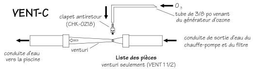
former dans la canalisation principale provenant de la pompe, forçant l'eau à passer par le venturi et augmentant ainsi la succion. Pour la plupart des systèmes, fermer le robinet aux trois quarts devrait créer suffisamment de succion pour que l'unité fonctionne de façon adéquate. Ajustez votre système (en ouvrant ou fermant) pour atteindre une succion idéale (5 SCFH). Le système de venturi 1 1/2 po a une capacité de 60 gpm (272,8 lpm), avec une baisse de pression de 5 psi.
